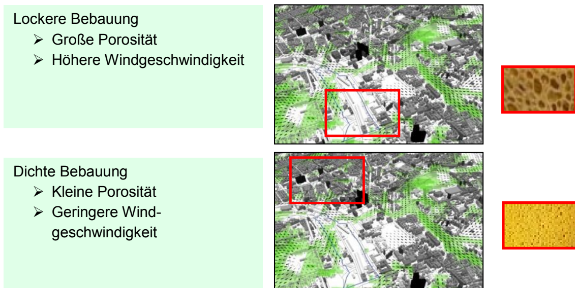
Abbildung 7: Einfluss der Bebauungsdichte auf die Strömungsgeschwindigkeit
