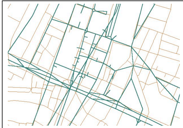
Abbildung 1: Beispiel eines genauen digitalen Netzmodells (braun) und eines ungenauen Straßennetzmodells (grün)
